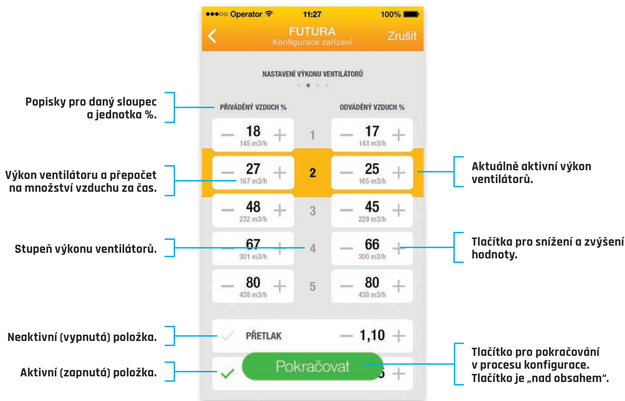
Obr. 4 - Nastavení výkonu ventilátorů
